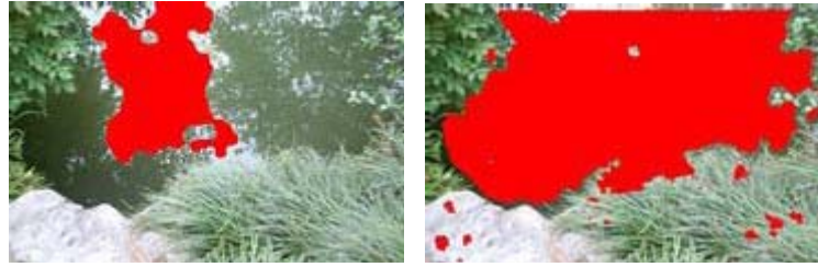
Gambar 11. Segmentasi warna citra permukaan air berdasarkan derajat polarisasi (KIRI) dan berdasarkan fase polarisasi (KANAN) (Binxie, 2007)
