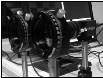
Gambar 11. Sistem Pencitraan Stereo untuk segmentasi area permukaan air
