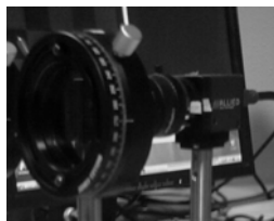
Gambar 7 Akuisisi Optik-mekanik menggunakan Polarizer rotator
