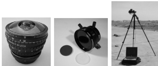
Gambar 15. Lensa Fisheye (kiri) cakram rotator linier polarizer (tengah) dan instalasi kamera (kanan)
